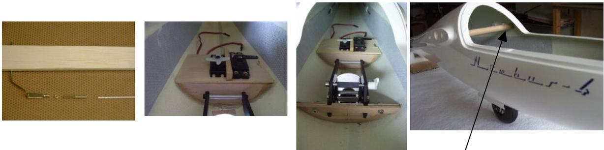
Zur Stabilisierung des Rumpfes wird jetzt im Bereich der Nasenleistenanformung am Rumpf ein Buchenrundholz mit 10 mm Durchmesser eingeklebt. (Siehe Bild oben rechts) Im Bereich der Endleiste wird der konturgefräste, mitgelieferte Verstärkungsspannt eingesetzt.
