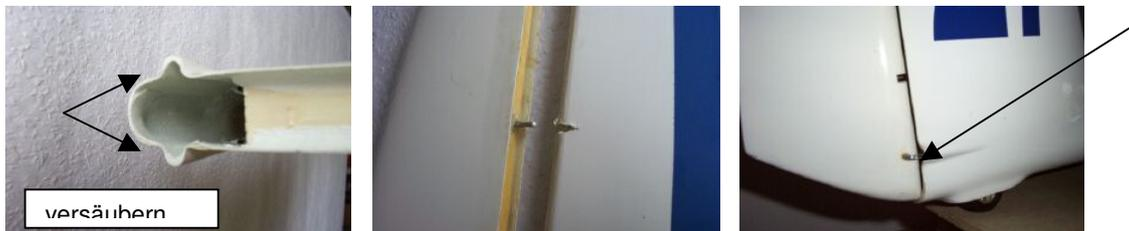
Die Position der Augenschrauben muss nun exakt auf das Seitenruder übertragen werden. Positionieren Sie das SR korrekt ausgerichtet und drücken Sie die Rudernase einfach gegen die Augenschrauben.
