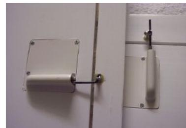
Bohren Sie in die QR /WK-Unterseite bis knapp unter die obere Beplankung ein Loch mit 10mm Durchmesser. Schaffen Sie unter der Beplankung – ohne die Beplankung zu verletzen zusätzlich etwas Platz – ca. 1mm im Umkreis. Die beiliegenden Hartholzdübel zur Aufnahme der Ruderhörner werden nun mit etwas Dickharz eingeklebt und nach dem Aushärten beigeschliffen.
