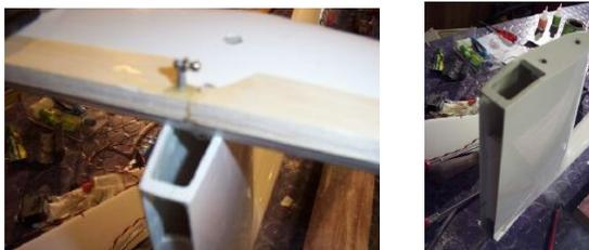
Die Anlenkung wird mittels Gabelkopf u. Gewindestange M 2,5 hergestellt. Die EWD von 1,5 Grad ergibt sich automatisch.
