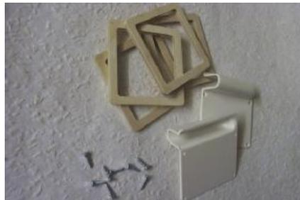
Nachdem die Servoschächte bis auf das Kohlegewebe an der oberen Beplankung versäubert sind, werden die Sperrholzrahmen in den dafür vorgesehenen Absatz eingepasst. Die Einbautiefe vor dem Einkleben bitte kontrollieren, indem der Kunststoffdeckel aufgeschraubt wird und nun mit der unteren Beplankung bündig sein muss. Sollte die Abdeckung zu tief sitzen, einfach zwischen Rahmen und Auflage etwas mehr eingedicktes Harz einbringen.
